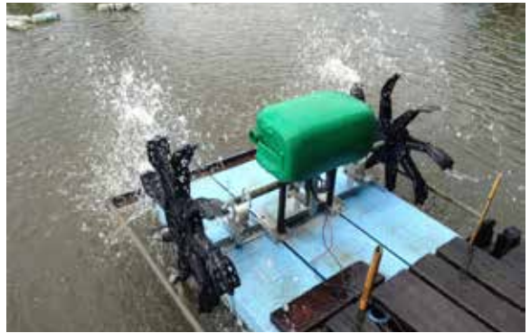
ระบบกังหันตีน้ำเพื่อเติมออกซิเจนในน้ำด้วยพลังงานแสงอาทิตย์
